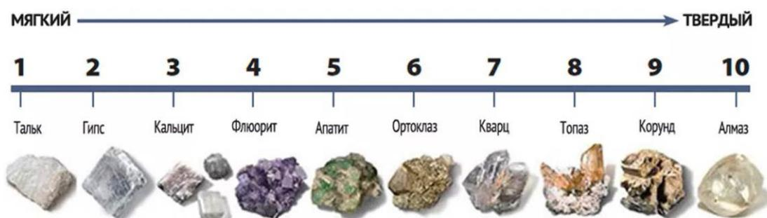
Рисунок 4.3 – Шкала Мооса (минералогическая шкала твердости)
