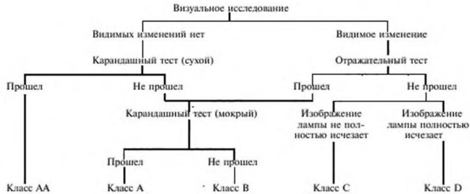
Рисунок 2.3 – Схема оценки результата химической стойкости к кислоте: AA – не обнаружено каких-либо изменений; А – заметно слабое потускнение; при штриховке карандашом не обнаруживается граница пятна; В – заметное потускнение; при штриховке пятна карандашом обнаруживается граница пятна; штриховка стирается сухой тканью; С – то же, но штриховка стирается лишь влажной тканью; Д – грубая матовость [35]
