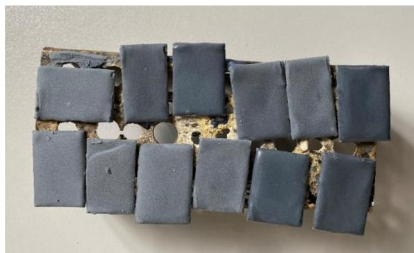
Рисунок 3.5 – Образцы с нанесенными грунтовыми эмалевыми покрытиями
