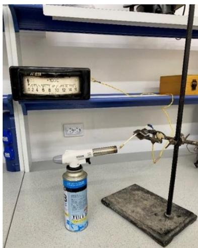
Рисунок 4.8 – Установка для измерения температуры факела горелки
